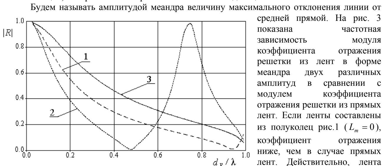
Рис.3. Зависимость модуля коэффициента отражения E-поляризованной волны от относительной частоты d_y/\lambda для решетки из лент с параметрами d_x = d_y , 2w/d_y = 0.05 , имеющих форму меандра для различных значений L_m/d_y : кривая 1 – 0.0, кривая 2 – 0.25, прямые ленты – кривая 3.
